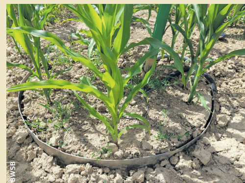
Abb. 4: Lysimeteroberfläche im Betriebszustand: während der Bodenbearbeitung wird der Stahlring (oberste 35 cm) entfernt und anschließend wieder eingesetzt.
