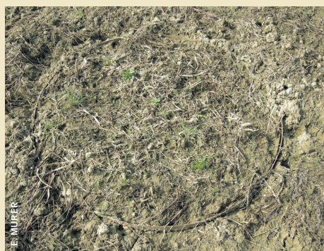
Abb. 4: Lysimeteroberfläche im Betriebszustand: während der Bodenbearbeitung wird der Stahlring (oberste 35 cm) entfernt und anschließend wieder eingesetzt.
