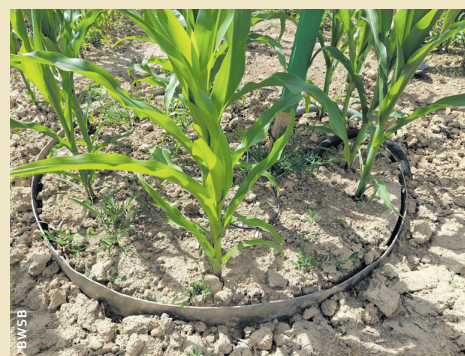
Abb. 4: Lysimeteroberfläche im Betriebszustand: während der Bodenbearbeitung wird der Stahlring (oberste 35 cm) entfernt und anschließend wieder eingesetzt.
